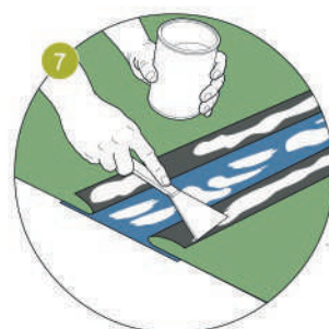
7 EXTIENDA EL PEGAMENTO SOBRE LA CINTA DE UNIÓN
