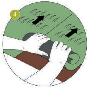
4 MANTENGA SIEMPRE LA MISMA DIRECCIÓN DEL ROLLO AL INSTALAR
